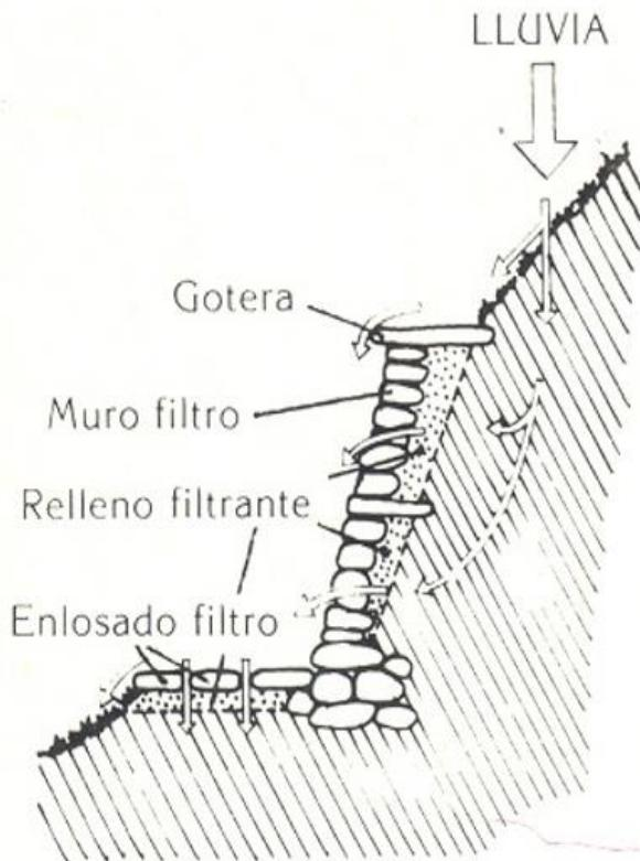
Funcionamiento de los muros como filtro.
