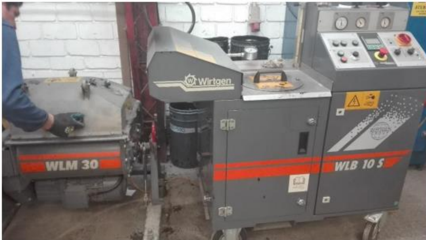
Figura 1. Planta móvil de producción de asfalto espumado de la Escuela Colombiana de Ingeniería Julio Garavito.
